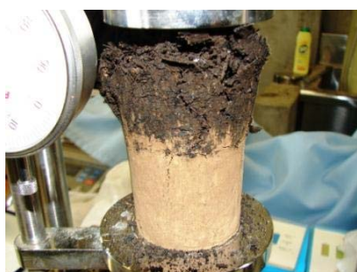
写真3 結合体の破壊状況
